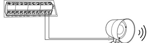
Se utiliza esta salida para conectar la sirena del sistema de alarma. Se pueden conectar más de una sirena, desde que la corriente total no sobrepase las especificaciones técnicas.
