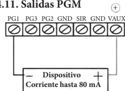
Figura 3 – Conexión de la PGM para dispositivos hasta 80 mA
