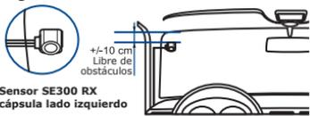
**ATENCIÓN:** Siga el mismo procedimiento para instalar el sensor SE300 TX en el lado derecho.
