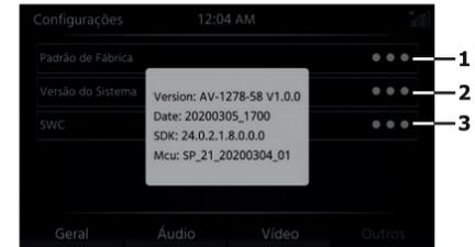
1. **Padrón de Fábrica:** Presione para volver a la configuración de fábrica.
